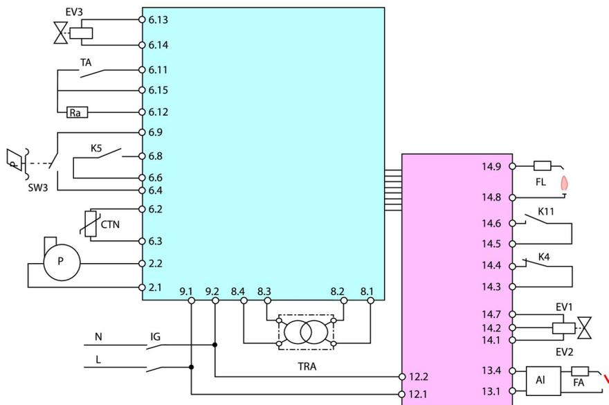
EV1 - EV2 - électrovannes de sécurité du mécanisme gaz
